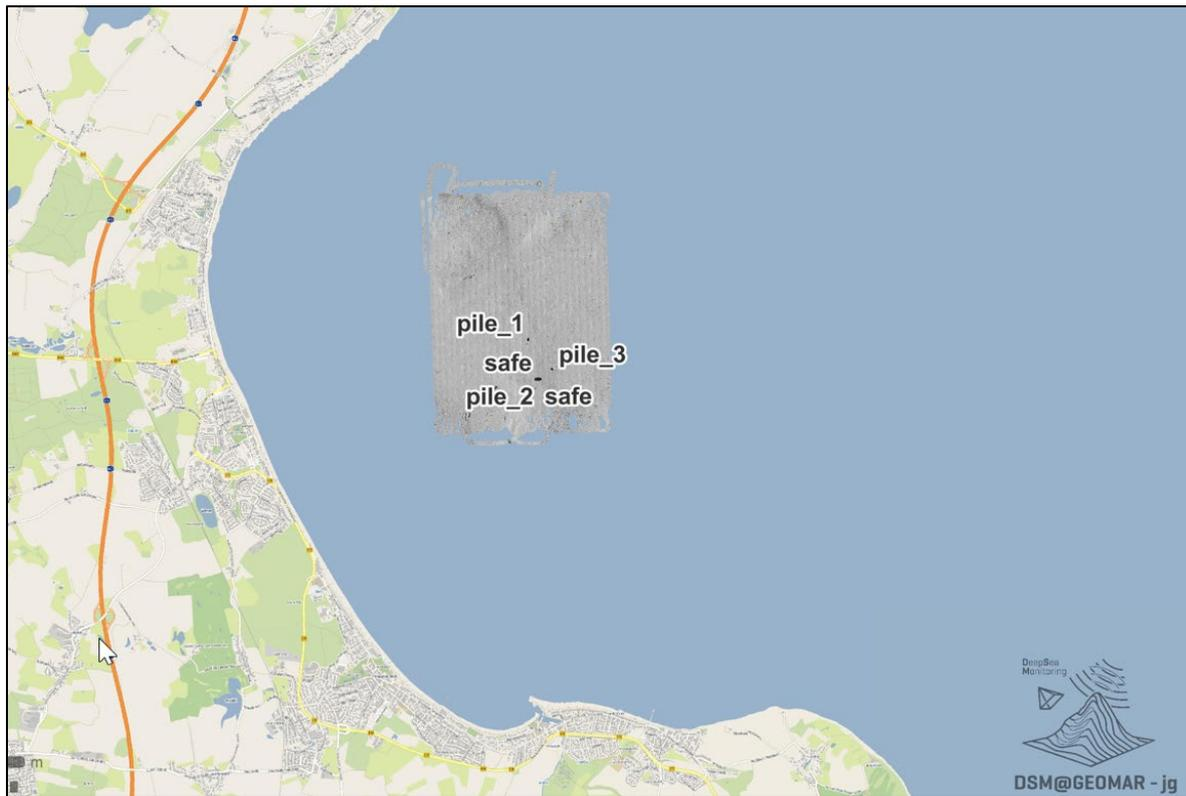
2 Die Multibeam Kartierung im Munitionsversenkungsgebiet vor Haffkrug zeigt drei Munitionshaufen (piles) und eine sichere Ankerstelle (safe). Quelle: GEOMAR.
