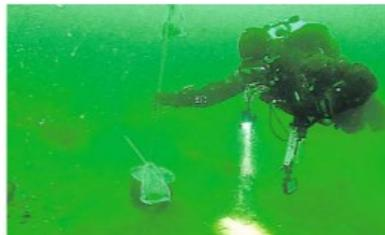
Taucher Tom Kürten setzt in der Nähe von Munitions-Alllasten eine Muschel-Mooring. Durch die Filterfähigkeit der Muscheln können sprengstoff-typische Verbindungen nachgewiesen werden.
