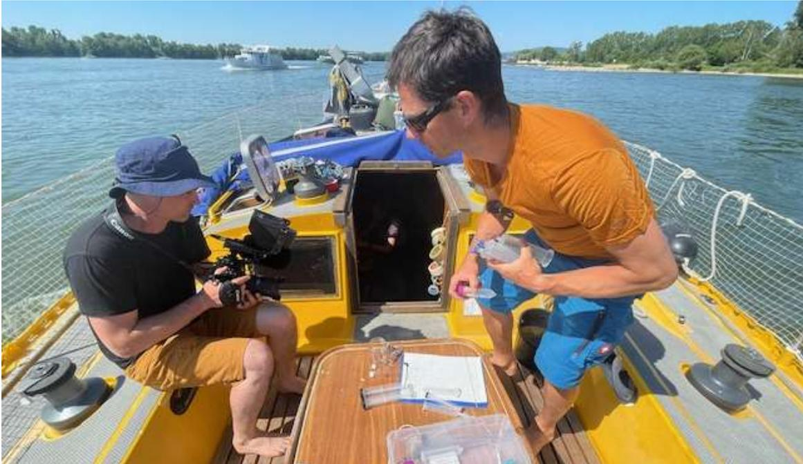
Und schließlich fanden von den Wissenschaftlern noch spezielle Messungen zur Wasserqualität statt. Mittels Sonden wurden kontinuierlich die Parameter Leitfähigkeit, Temperatur, pH- und Sauerstoffgehalt sowie Nitrat, gelöster Kohlenstoff, Chlorophyll und Trübung gemessen. Darüber hinaus wurden Koffeinwerte und über eine spezielle Sonde Öl im Wasser gemessen, um Aussagen zum Zustand des Gewässers und um die Wasserqualität mit menschlichen Einflüssen in Bezug zu setzen.
